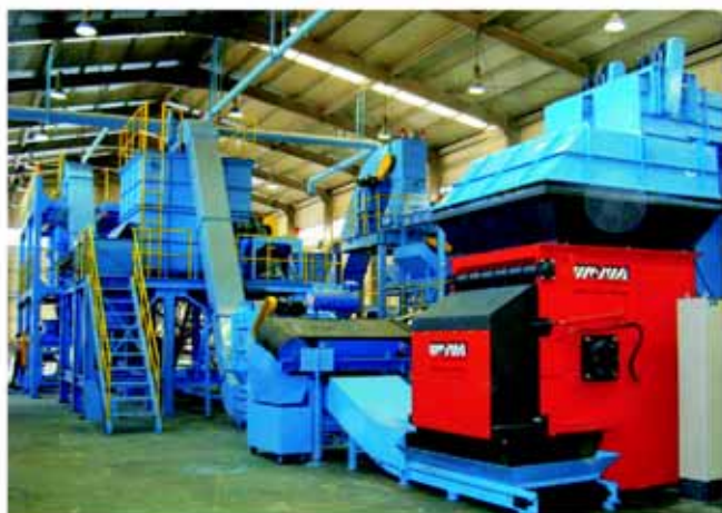
WLK Jumbo do rozdrabniania folii WLK Jumbo для измельчения пленки
