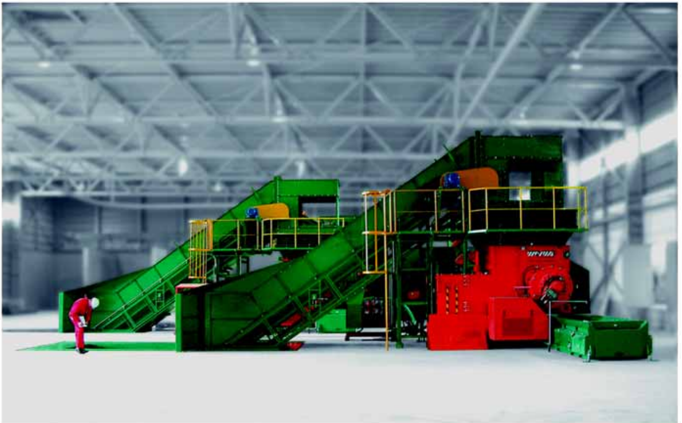
WLK Super-Jumbo z napędem hydraulicznym, Shinwa Sangyo (Japonia)
