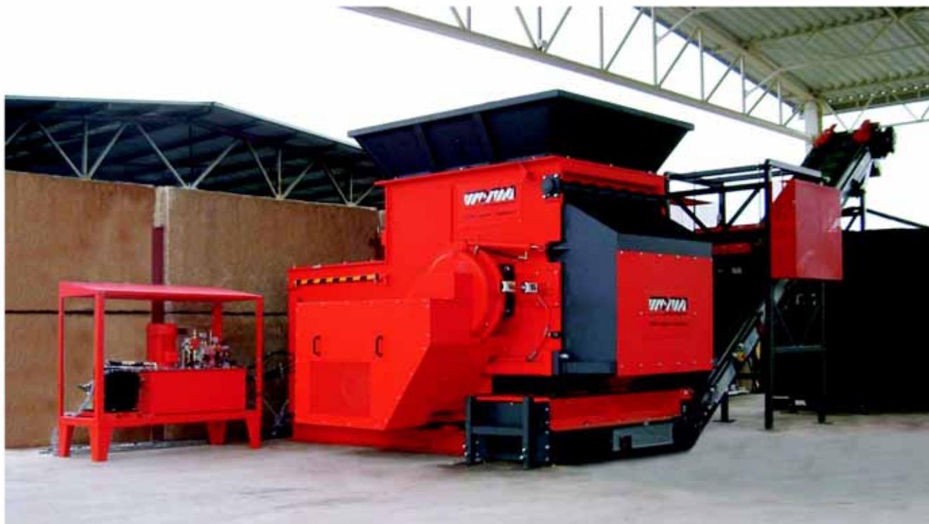
WLK JUMBO – rozdrabnianie wykładzin / WLK JUMBO – измельчение покрытий
