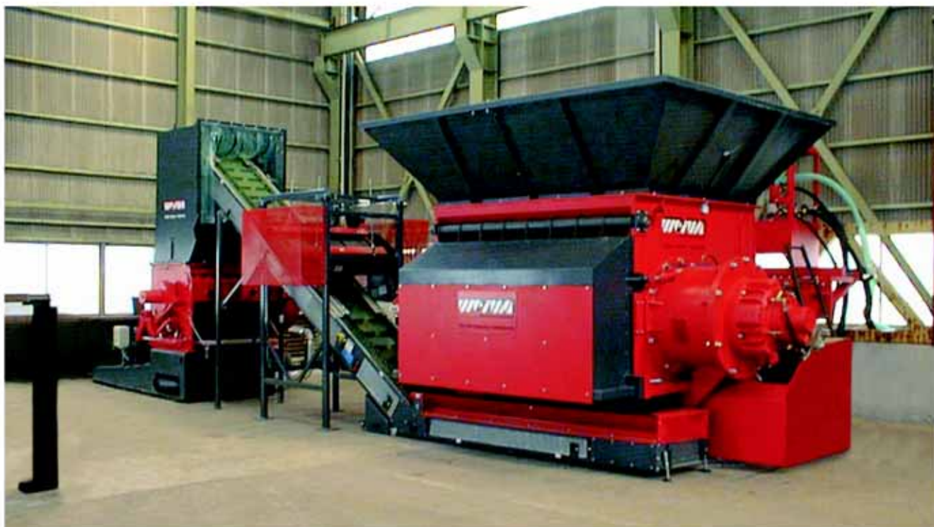
WLK Jumbo – dwustopniowe rozdrabnianie rur / WLK Jumbo двухступенчатое измельчение труб
