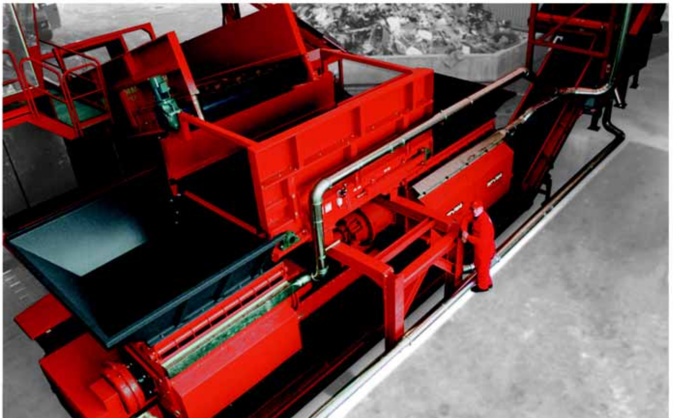
Kombinacja WLK 30 Super-Jumbo z napędem hydraulicznym i WLK 20 Super-Jumbo z napędem mechanicznym, XO-Group (Finlandia)
