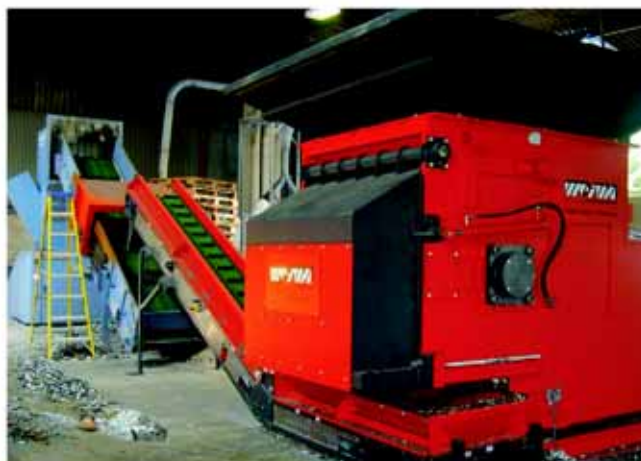
WLK Jumbo do rozdrabniania zlepków WLK Jumbo для измельчения слитков
